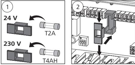
Abhängig von der eingelegten Sicherung (im Lieferumfang enthalten), kann die B 50302 an 24 V oder 230 V Spannungsquellen betrieben werden.
