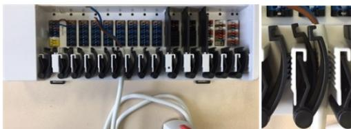
Die Zugentlastungen sind für flexible Leitungen mit einem Kabelmanteldurchmesser von 5 mm bis 8 mm geeignet, wobei primär die untere Zugentlastung (wie abgebildet) verwendet werden soll.
